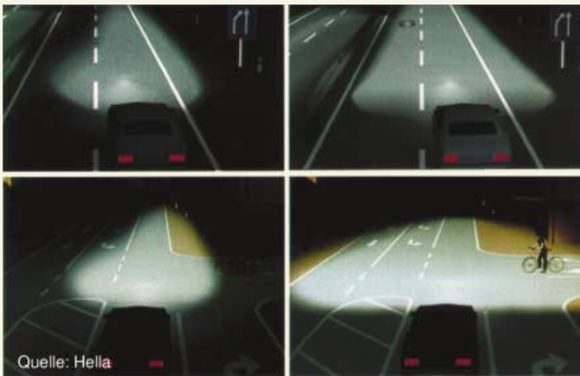
Bild 2: Risikovermeidung durch optimierte Ausleuchtung der vorausliegenden Strecke – heutiges Fahrzeuglicht (links) im Vergleich mit neuen Scheinwerfersystemen (rechts)
