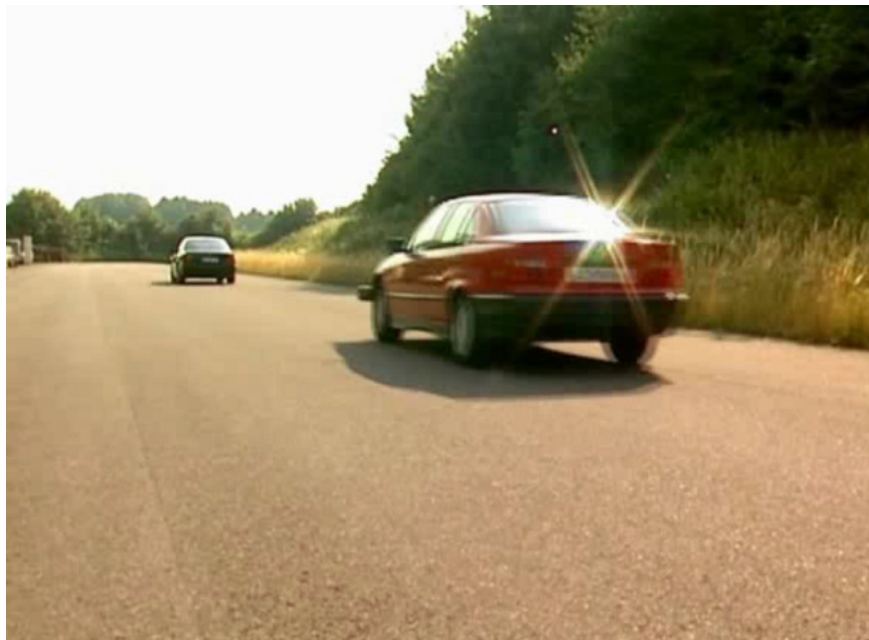
Bild 2: Versuchsträger des Instituts für Kraftfahrwesen für die Entwicklung und Bewertung von Fahrerassistenzsysteme in der automatischen Folgefahrt
